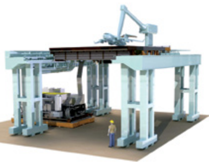
DNW 风洞试验系统所拥有的移动路面系统能够更加准确地模拟飞机的近地面效应，完成新型号飞机的气动外形设计，也可以实现现有型号飞机的设计优化。
