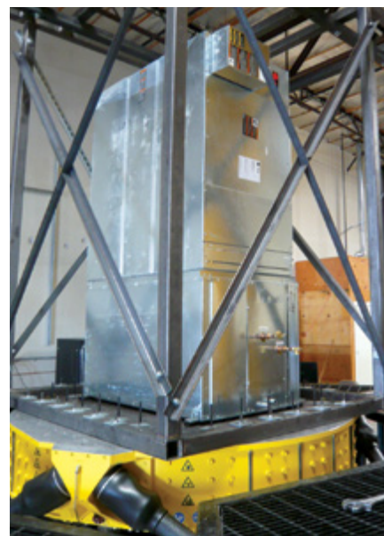
MTS 353.20型多轴振动模拟(MAST)系统让DCL试验室快速建立起符合OSHPD认证规范的试验能力。
