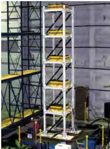
五层建筑结构附加阻尼系统测试
