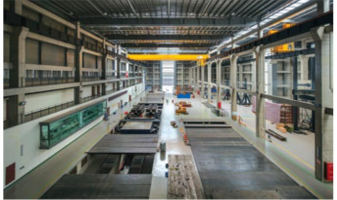
同济大学的多功能振动台阵系统包含两个最大负载为70T的振动台和两个最大负载为30T振动台，这四个振动台可以在相邻的沟槽内移动，组合成为多台阵系统。
