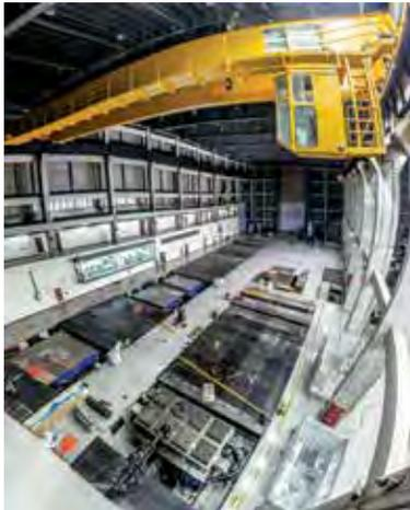
“我们具备开展更大尺度样件的测试能力，可以获取更加真实的仿真数据，我们不再费时费力地搭建完整的建筑模型，只需做几个子结构或者做个局部的模型就可以完成整个建筑物的抗震模拟测试。这项技术的发展可能开启了工程结构测试与仿真的一个新时代。”
