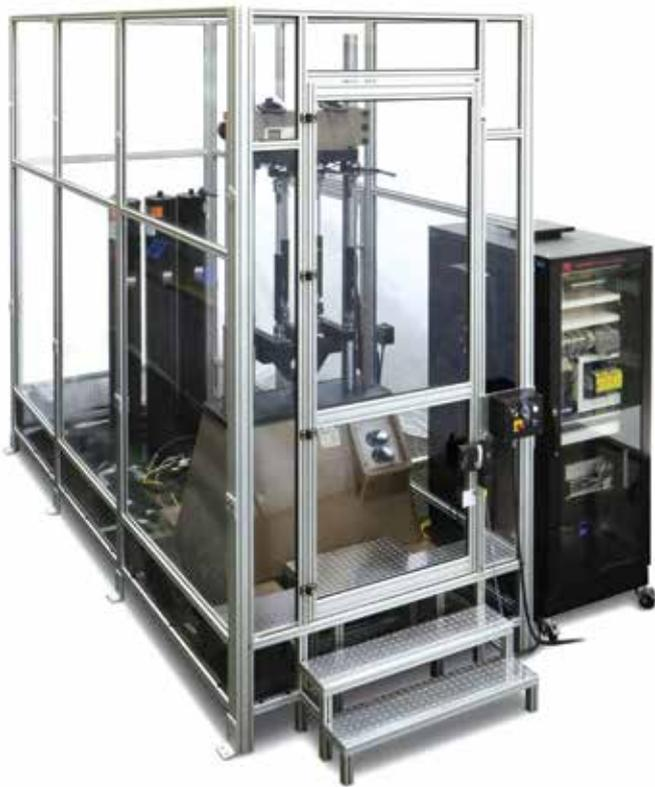
MTS车辆减震器测试解决方案采纳了功能强大、灵活的数字控制器，满足全方位的测试应用需求。这些标准的测试系统具有最高8kHz的闭环控制速率，某些控制器还可以提供高达20kHz的数据采集能力。
