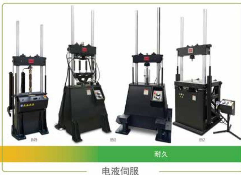
MTS车辆减震器测试解决方案包括完整的高性能加载框架产品，全方位满足减震器产品的测试应用需求。
