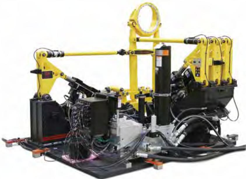
全新设计的329i型六自由度道路模拟器集成了最新的MTS电液伺服产品、升级性能的伺服控制器和软件, 可实现更高的性能、效率、精度和互联性要求。
