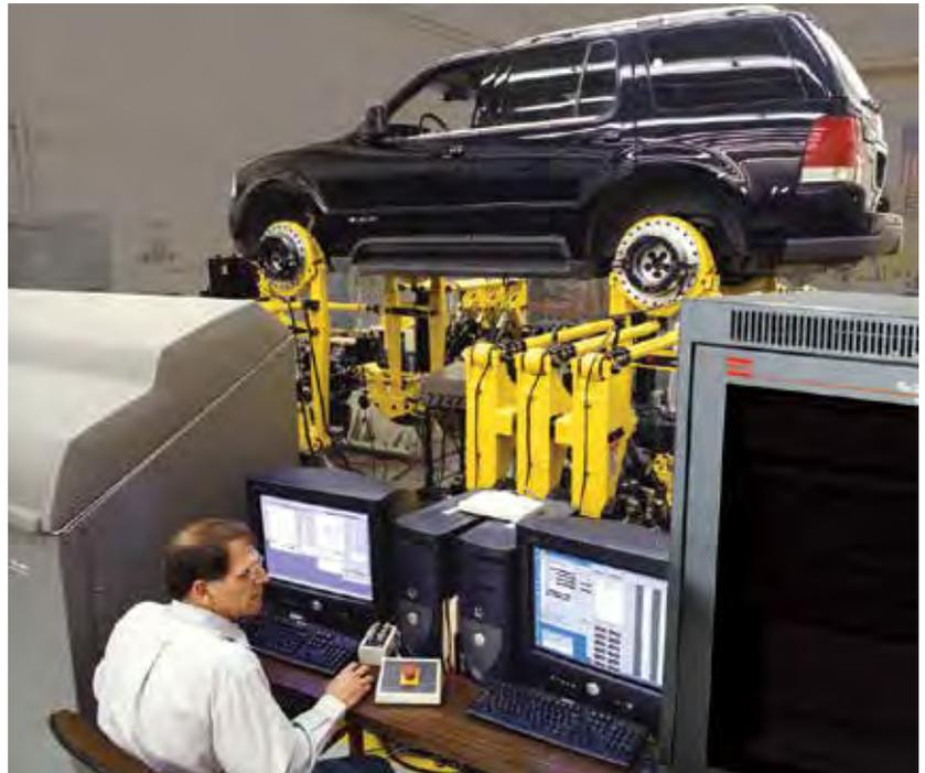
应反相控制(AIC)等等，仔细分析客户应用需求，选择正确的软硬件配置，实现高精度的道路模拟试验。
