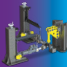
液压作动缸, 不具备主动 On/Off、High/Low逻辑
